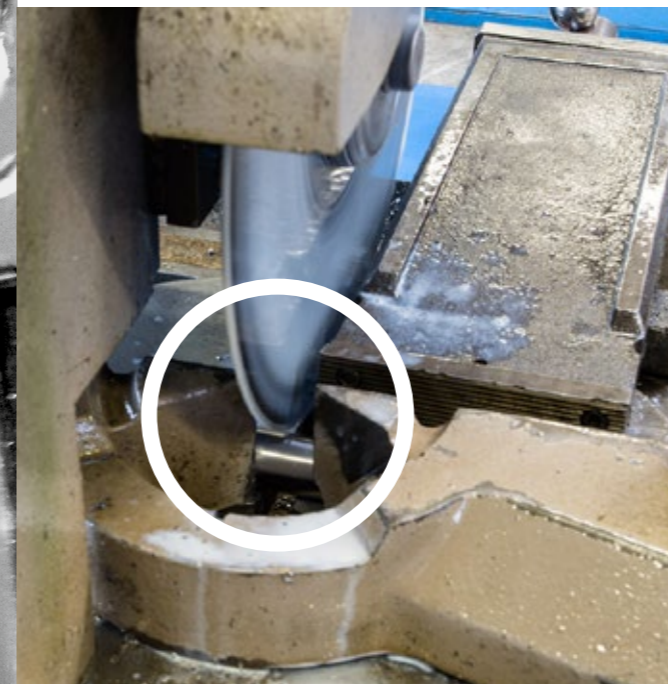
Mit einem 3-mm-Sägeblatt aus gehärtetem Stahl wird den Stahlstangen zu Leibe gerückt. The steel rods are tackled using a 3 mm saw blade made from hardened steel.
